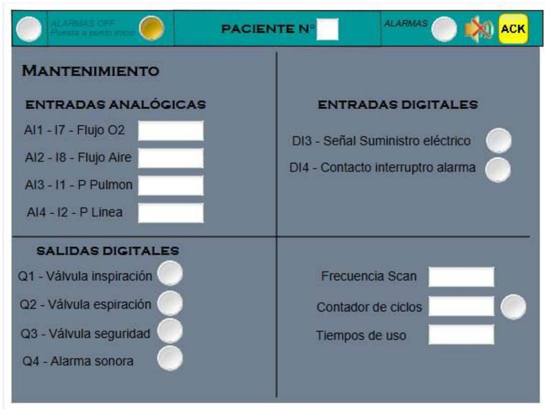
Fig. 15. Pantalla de mantenimiento
