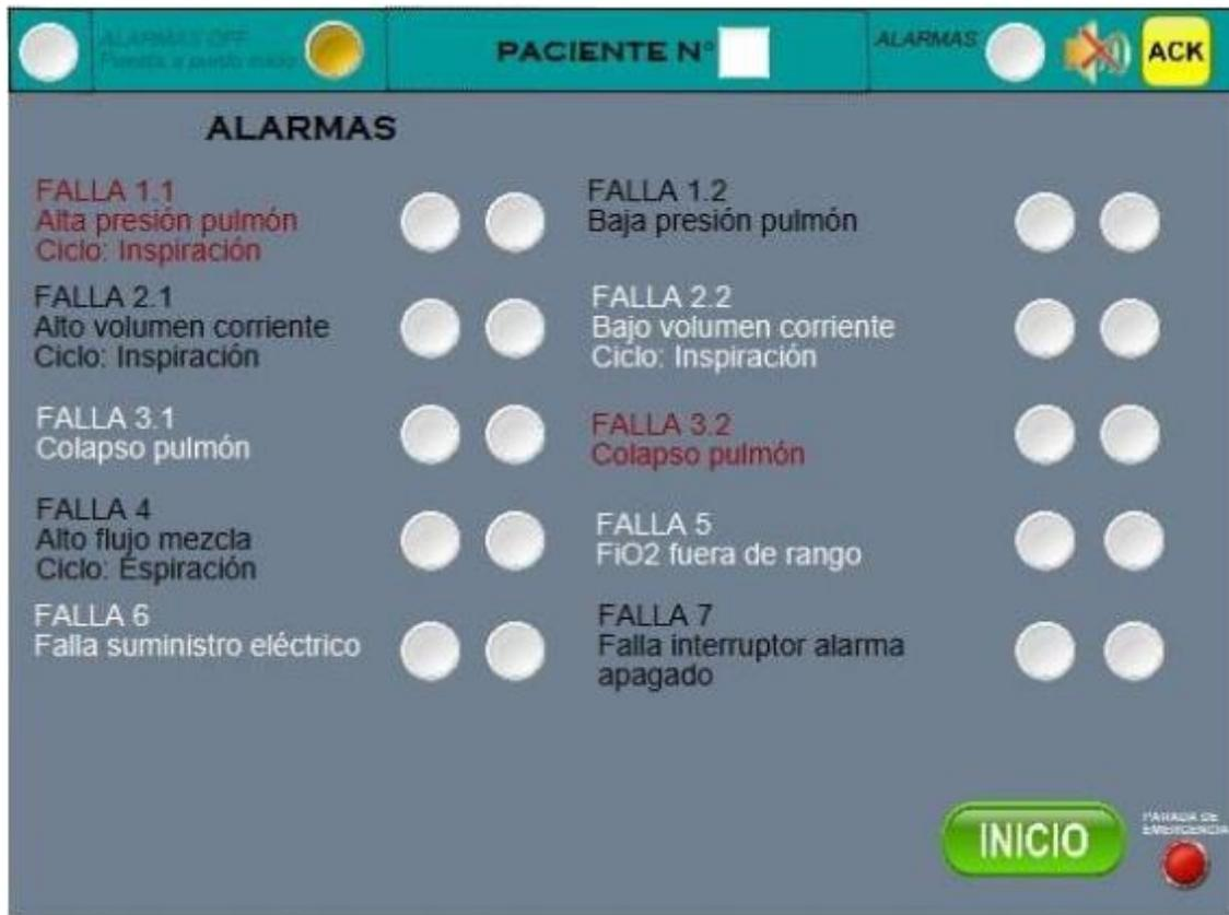
Fig. 13. Pantalla de visualización de alarmas.
